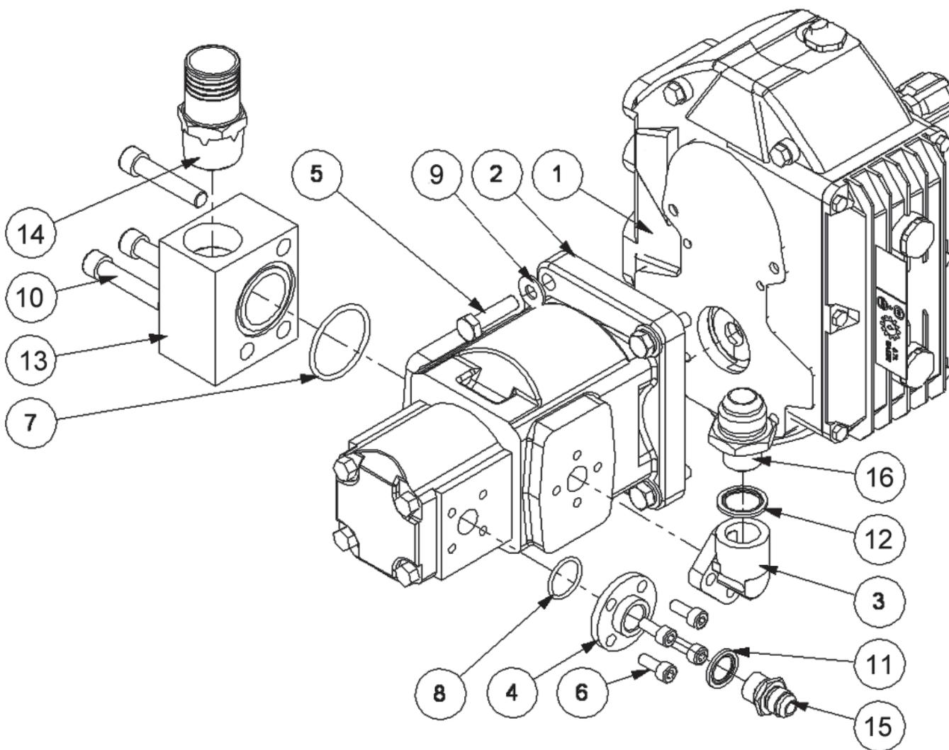
**PUMP AND GEARBOX ASSEMBLY - BIMA**
